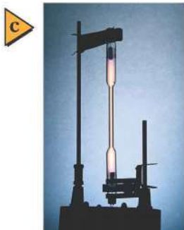
■ الشكل 4-5 عند تطبيق فرق جهد عال على عينة غاز يبعث الغاز ضوءاً ذا توهج خاص به؛ فيتوهج غاز الهيدروجين بضوء أحمر مزررق (a)، ويتوهج غاز الزئبق بضوء أزرق برتقالي - وردي اللون (c).
