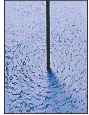
■ الشكل 9-1 يظهر المجال المغناطيسي حول سلك يمر فيه تيار كهربائي ويخترق قرصاً كرتونياً في صورة دوائر متحدة المركز من برادة الحديد حول السلك.
