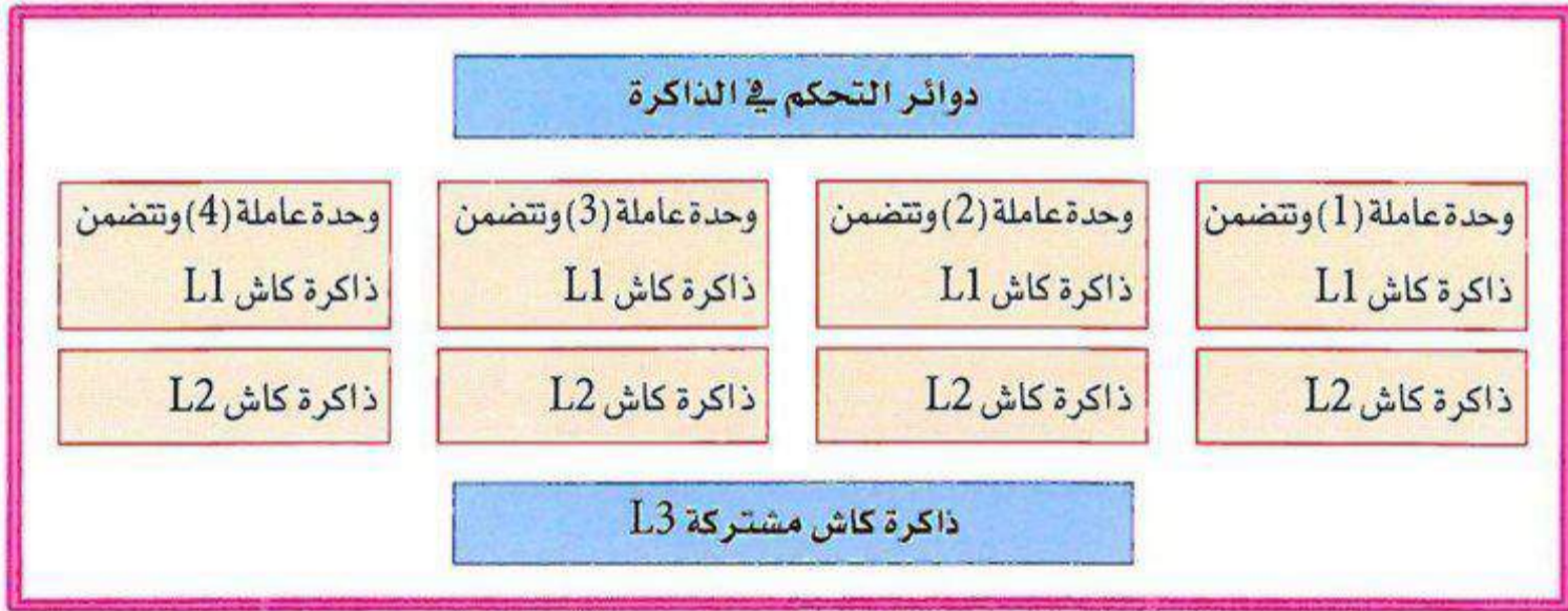
شكل (٥-٦): نموذج مبسط للبنية الداخلية لمعالج متعدد الوحدات (multi-core)
