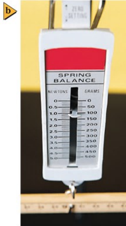
■ الشكل 12-1 عند النظر إلى التدريج بشكل عمودي كما في (a) تكون قراءتك أضبط مما لو نظرت بشكل مائل كما في (b).
