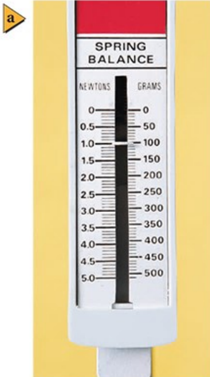
■ الشكل 12-1 عند النظر إلى التدريج بشكل عمودي كما في (a) تكون قراءتك أضبط مما لو نظرت بشكل مائل كما في (b).
